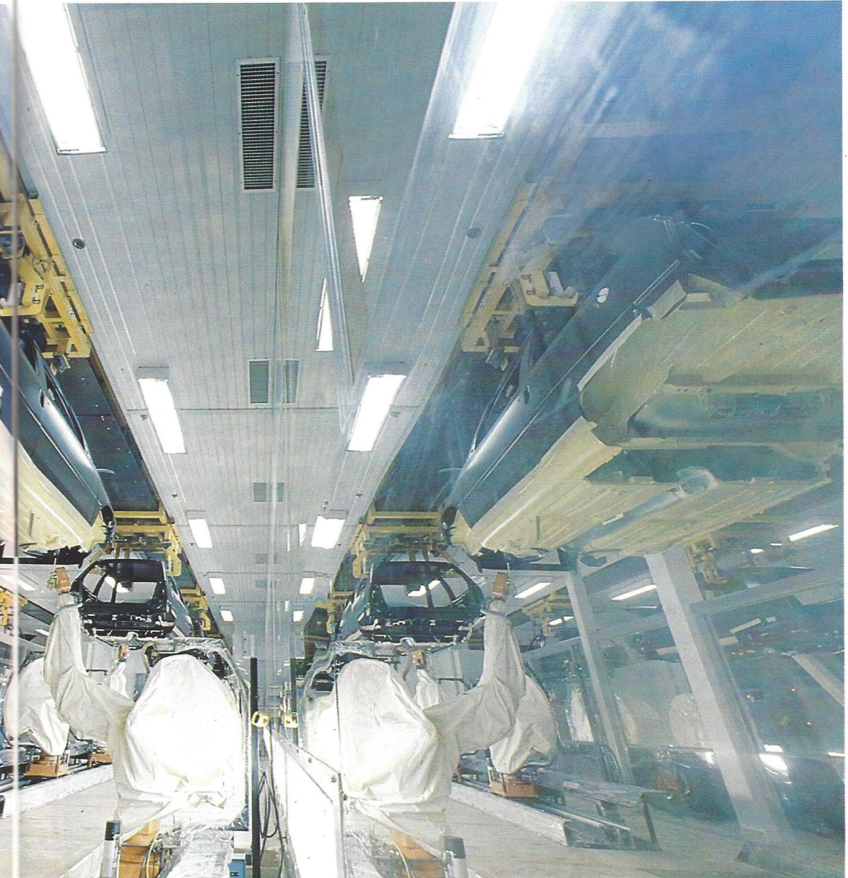
Pose automatisée des mastics antigravillonnage sur les dessous de caisses. Photo A. Béranguier (Citroën C.87.190.3) The underbody is protected from grit
