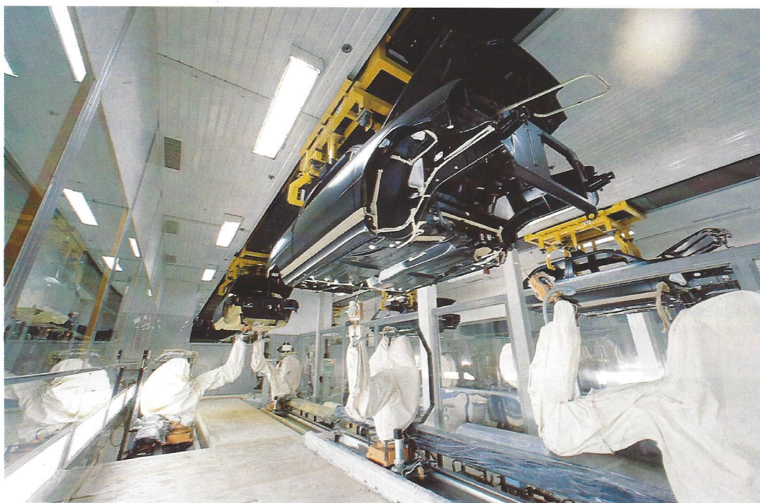
Pose automatisée des cordons de mastic pour l'étanchéité Photo A. Bérenguer (Citroën C.87.190.4) Automated application of sealing compound
